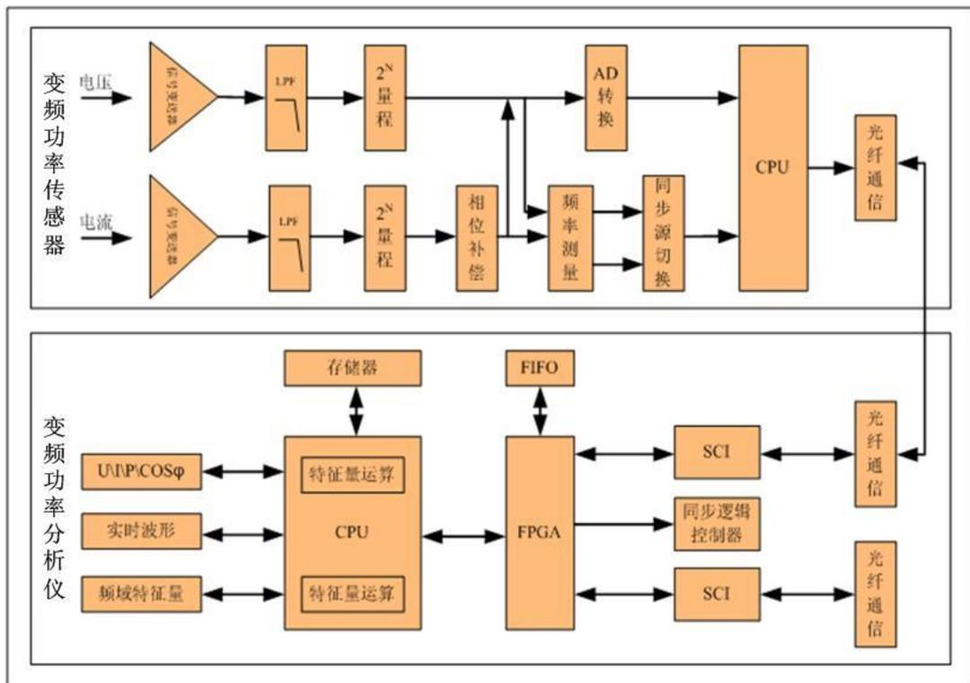
电压、电流信号经传感器内部感应器件变送后变为低电压信号，该信号经过抗混叠低通滤波器后，在 CPU 的干预下进行自动或手动量程转换，量程转换后的电压信号直接进入 AD 转换器和频率测量电路，电流信号经过相位补偿进入 AD 转换器和频率测量电路，在 CPU 干预下自动或手动选择电压或电流信号为同步源。CPU 将采样信号通过光纤收发器与 WP4000 变频功率分析仪进行通讯。
